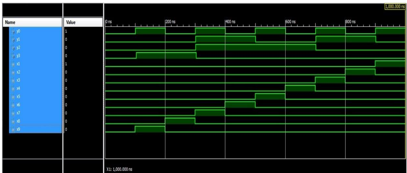
Рисунок 15 - Временная диаграмма шифратора в программной среде XILINX
